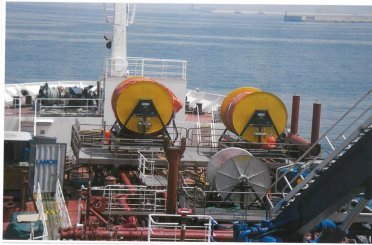
Fig. 8 Boom winch
